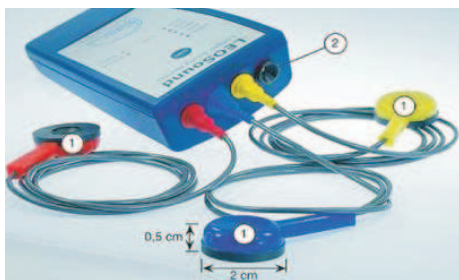
Der „Lungen-Sound-Recorder“ mit drei bioakustischen Sensoren (im Bild mit 1 gekennzeichnet) und Umgebungsmikrofon (im Bild mit 2 gekennzeichnet). Die weiche und flache Ausführung der Sensoren ermöglicht bequemes und komfortables Liegen auch in Rückenlage.
